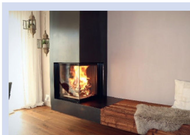
Speichercheminée als Aufsatzspeicher mit Hutte aus Schwarzstahl und Bank aus Fichte
